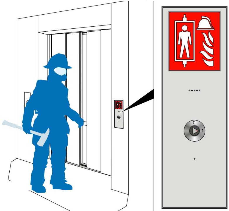
Imagen 4. Ascensor de bomberos
