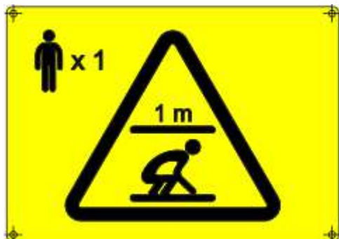
Imagen 10: Pegatina para espacio de refugio en el sobrerrecorrido o en el foso.
